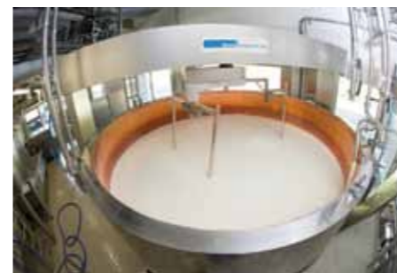
Im grossen, kupfernen Käsekessi wird die Rohmilch erwärmt und eingelabt.
