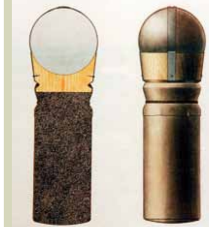
Das Vollkugelgeschoss aus Eisen der 6-pfünder-Vorderlader-Artilleriekanone, Ordonnanz 1843, wie es 1866 in Murten zum Einsatz gelangte (Kugelgewicht 2,860 kg, Schwarzpulverladung 750 g, Mündungsgeschwindigkeit 435 m/s). Bild: Verein Schweizer Armeemuseum
