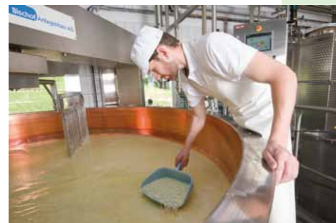
Nachdem die Gallerte mit der Harfe geschnitten wurde, wird die Körnung geprüft.
