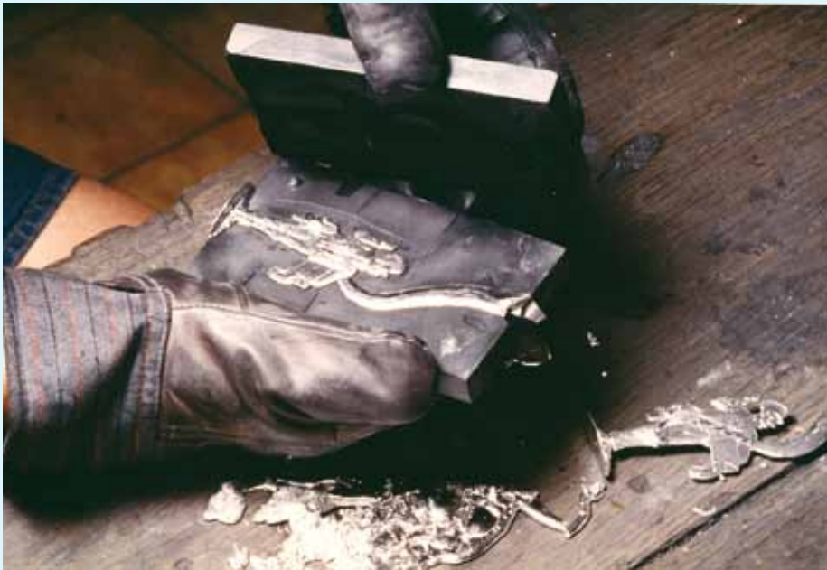
Schon wenige Sekunden nach dem Guss kann der silberglänzende Rohling der Form entnommen und von Eingusszapfen und Lufttrompeten befreit werden.
