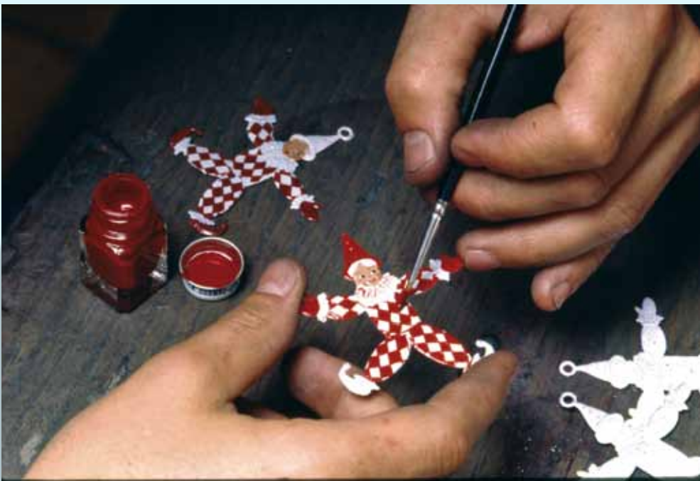
Dann werden die Figuren entgratet und poliert, bevor ihnen durch individuelle Handbemalung eine Seele eingehaucht wird.
